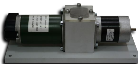
Агрегат стенда тип «2» (БДПТ-ДПТ)
